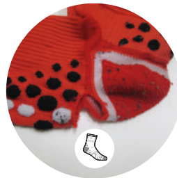
PRSV3 & FULL SOCKS PRODUCT RIPPED AT THE STITCHING PRODUIT TROUÉ AU NIVEAU DE LA COUTURE PRODUCTO ROTO EN LA COSTURA
