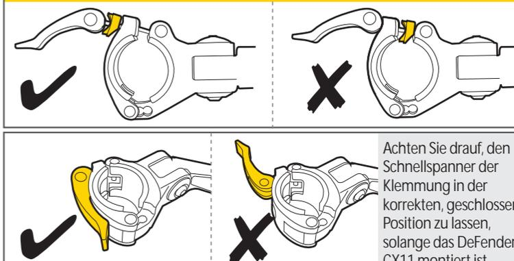
Achten Sie drauf, den Schnellspanner der Klemmung in der korrekten, geschlossenen Position zu lassen, solange das DeFender™ CX11 montiert ist.
