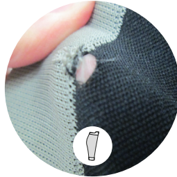
CALFS (RSV2, UR2V2, USV2, PRO R2SWISS) PRODUCT RIPPED AT THE STITCHING PRODUIT TROUÉ AU NIVEAU DE LA COUTURE PRODUCTO ROTO EN LA COSTURA
