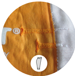
CALFS (RSV2, UR2V2, USV2, PRO R2SWISS) HOLE IN AN AREA OTHER THAN THE STITCHING TROUS RILLEURS QUE SUR LA COUTURE AGUJERO EN UNA ZONA QUE NO SEA LA COSTURA
