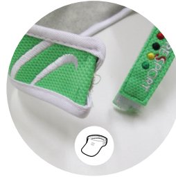
VISOR CAP PRODUCT RIPPED AT THE STITCHING PRODUIT TROUÉ AU NIVEAU DE LA COUTURE PRODUCTO ROTO EN LA COSTURA
