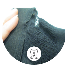
SHORTS PRODUCT RIPPED AT THE STITCHING PRODUIT TROUÉ AU NIVEAU DE LA COUTURE PRODUCTO ROTO EN LA COSTURA
