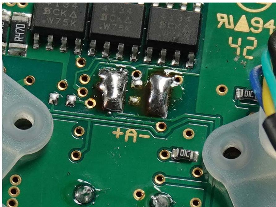
Länge das Lichtkabel so ab, dass maximal ein Zentimeter der Leiteradern zu sehen ist. Die Enden abisolieren und sorgfältig verzinnen.
