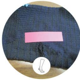
KOMPRESSIOnSsOcken (FULL SOCK ULTRALIGHT) LOCH NICHT AN EINER NAHT
