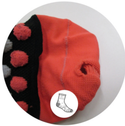
KOMPRESSIOnSsOcken (PRO RACING SOCKS V3.0, FULL SOCKS) LÖCHER DURCH ZEHENNÄGEL
