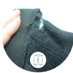
SHORTS MATERIAL AN DER NAHT GERISSEN
