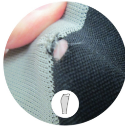
WADENKOMPRESSOREN (RSV2, USV2, PRO R2SWISS) MATERIAL AN DER NAHT GERISSEN
