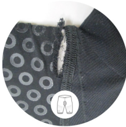
SHORTS MATERIAL AN DER NAHT GERISSEN
