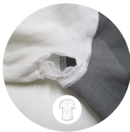
OBERTEILE (T3 AEROTOP, TR3 TANK TOP, TRAIL SHIRT, TRAIL TANK) MATERIAL AN DER ACHSELNAHT GERISSEN
