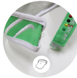
VISOR MATERIAL AN DER NAHT GERISSEN
